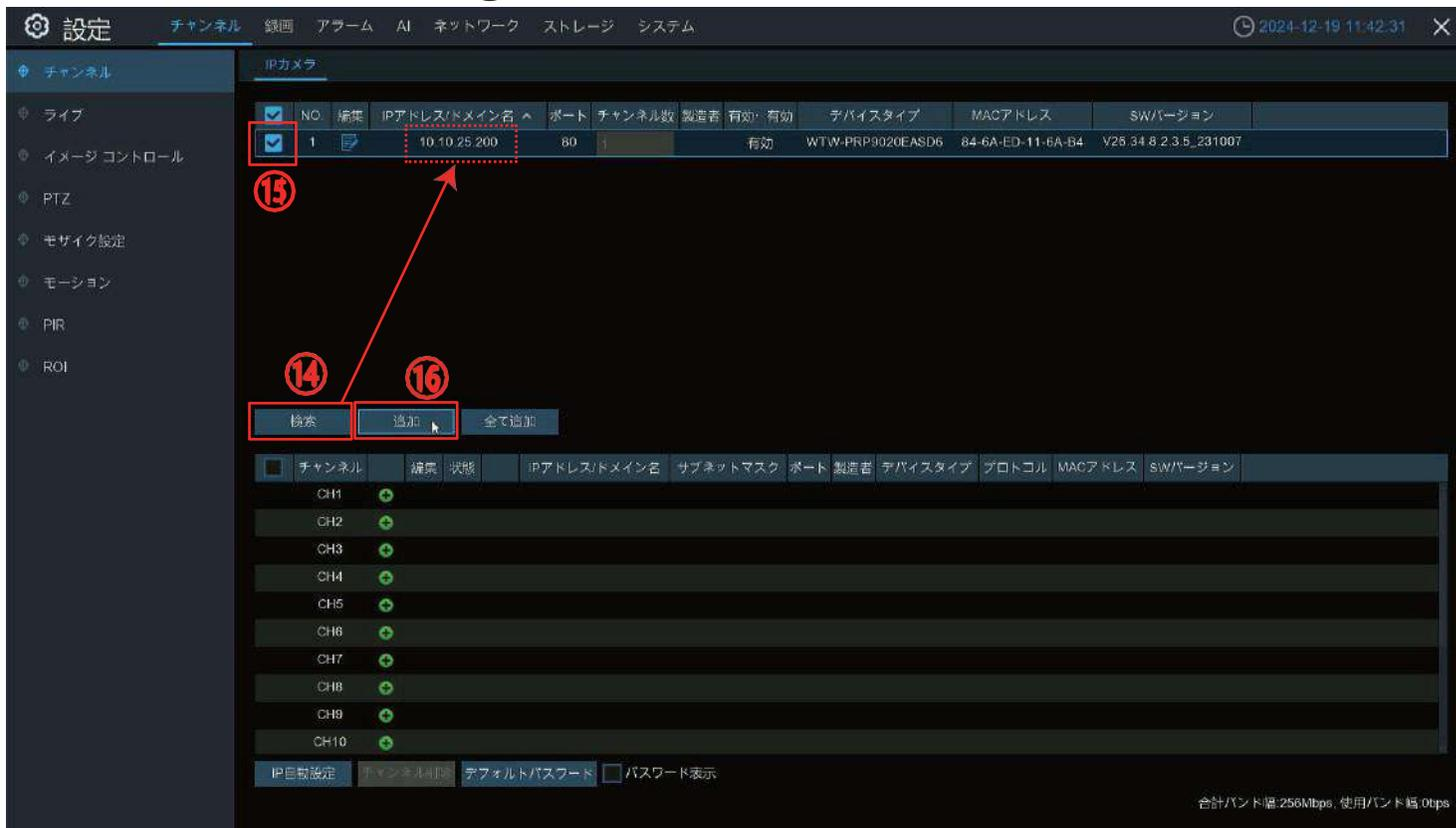
⑭検索を左クリックしカメラのIP アドレスが変更されているか確認をする
